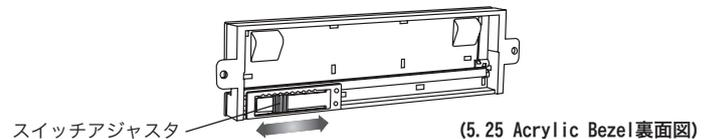
2. 光学ドライブを搭載する段の5.25インチベイパネルを5.25インチベイまたはフロントシャシーから取り外します。
