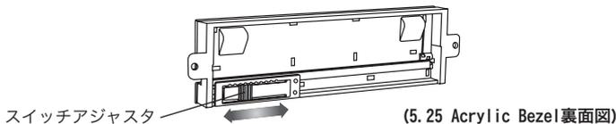
2. 光学ドライブを搭載する段の5.25インチベイパネルをフロントパネル(裏面)から取り外し、5.25 Acrylic Bezelを取り付けます。
