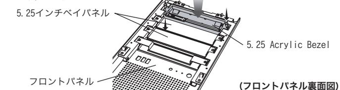
3. 光学ドライブをPCケース本体の前面から挿入し、5.25インチベイに固定用のネジ(ミリネジ)を使って仮留めをします。
